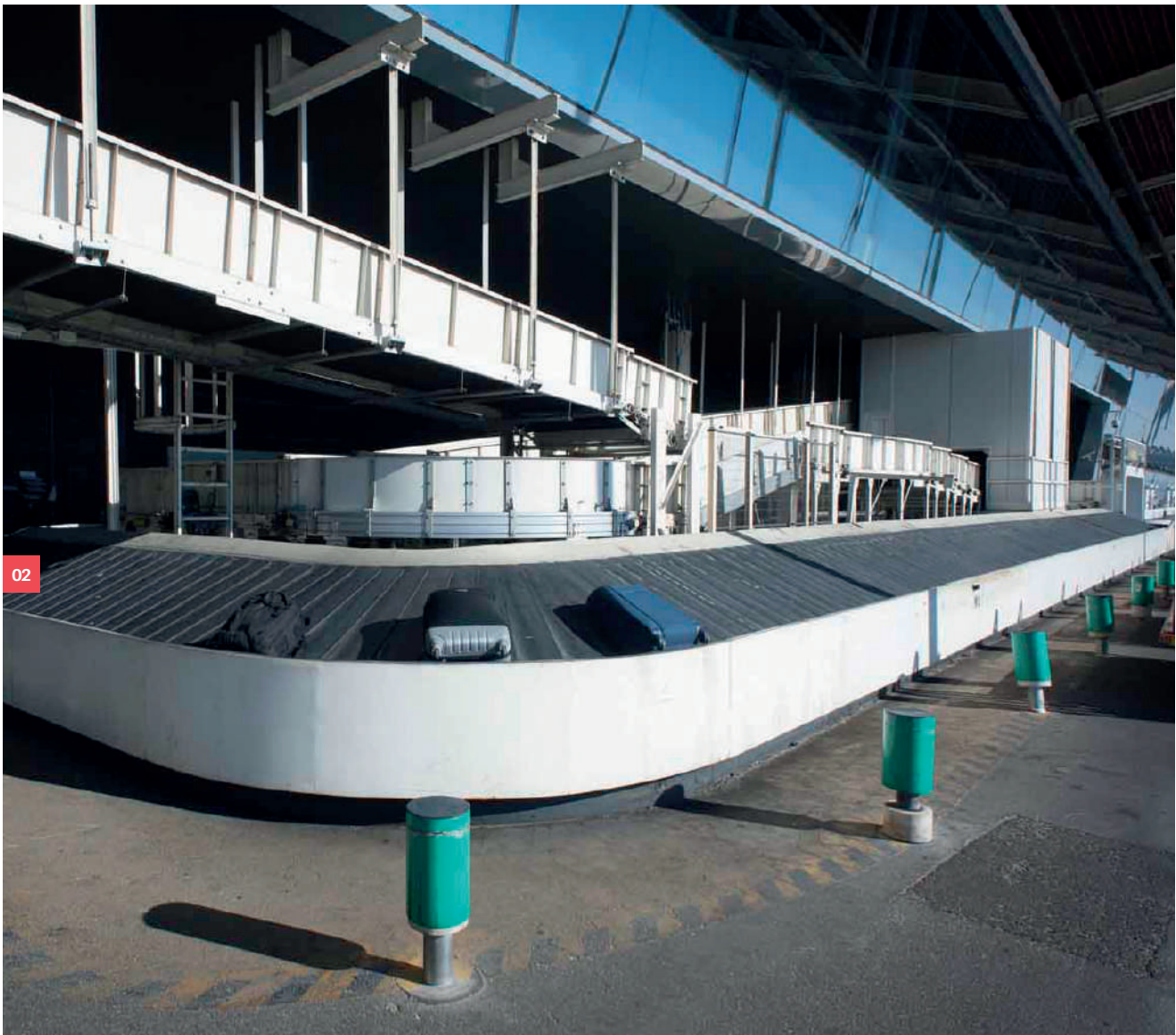
01- Sala de control. 02- Gestión de equipaje mediante carrusel inclinado.
